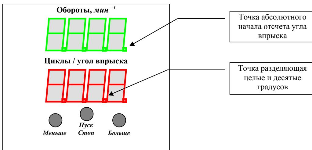
**Обороты, мин<sup>-1</sup>:** индикатор, отображающий частоту вращения вала привода.
